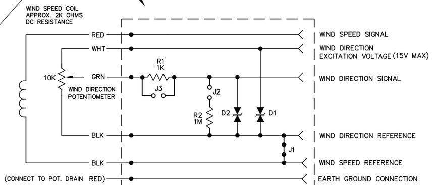
JUMPER J1 CONNECTS THE WIND DIRECTION AND WIND SPEED REFERENCES. IN APPLICATIONS WHERE THE TWO REFERENCES NEED TO REMAIN SEPARATE, JUMPER J1 MUST BE OMITTED OR CUT.
