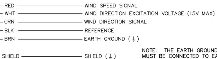
NOTE: THE EARTH GROUND TERMINAL MUST BE CONNECTED TO EARTH GROUND TO PROVIDE A STATIC DISCHARGE PATH.
