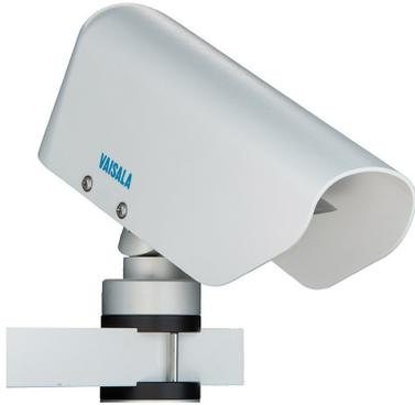
DST111 为测量路面温度提供了一种遥感测量方案。传感器能够测量路面发出的红外辐射并进行智能信号处理，从而提供可靠的遥感路面温度测量。
