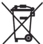
Diese durchgekennzeichnete Mülltonne bedeutet, dass Sie Batterien und Akkus nicht im Hausmüll entsorgen dürfen. Unter diesem Zeichen finden Sie manchmal auch zusätzlich nachstehende Abkürzungen im Bezug auf die Inhaltsstoffe: Pb = Blei, Cd = Cadmium und Hg = Quecksilber.
