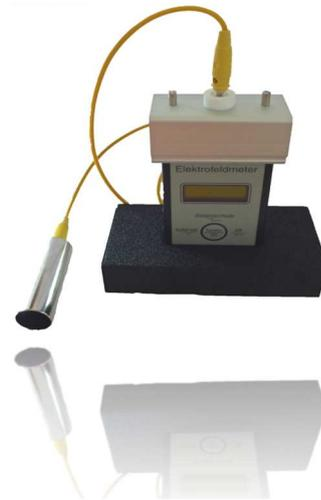
**MK 023** – Spannungsmesskopf bis  $\pm 4\text{kV}$  – Aufsatz zum Messen von Gleichspannungen mit einer Eingangsimpedanz von  $10^{16}$  Ohm
