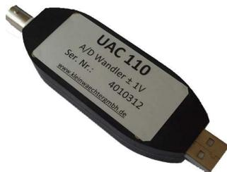
**UAC 110 A/D** – Wandler mit Eingangsspannung  $\pm 1V$
