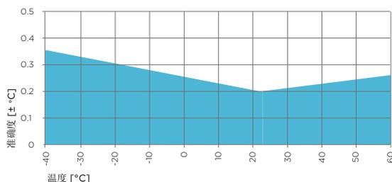
全量程的 HMP1 温度测量准确度
