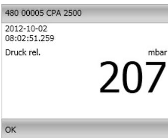
Bei einer laufenden Aufzeichnung wird zusätzlich zur Kurve noch von jedem aufgezeichneten Gerät eine Großanzeige angezeigt. Hier wird der Messwert, die Einheit, Messart, der Zeitpunkt der letzten Aktualisierung sowie der Gerätestatus angezeigt. Nach beendeter Aufzeichnung wird die Großanzeige automatisch wieder geschlossen.
