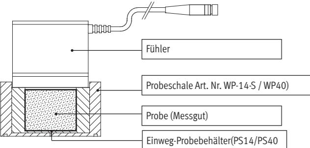
**Von der Umgebungstemperatur unabhängige Messung durch thermostatisierbare Probeschale.**
