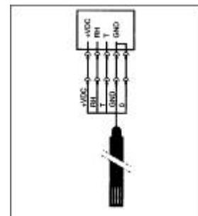
Wird das 5-adrige Kabel mit einem ebenfalls fünfadrigen verlängert, aber mit einem 4-poligen Stecker abgeschlossen, kann man an diesem die Kompensation „0“ mit der gemeinsamen Masse „GND“ verbinden. Die Kabelkompensation wirkt in diesem Fall im fünfadrigen Kabel bis zum 4-poligen Stecker
